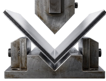
Alüminyum Kompozit Panel Büküm ve Katlama İşlemi.
