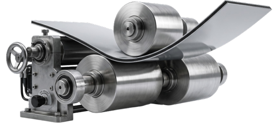
Alüminyum Kompozit Panellerde Silindir Büküm ve Kavis Verme İşlemi.
